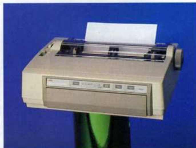
Vielseitig: Vorwärts oder rückwärts transportiert der NEC P2200 das Papier, neigt aber zu Papierstaus
